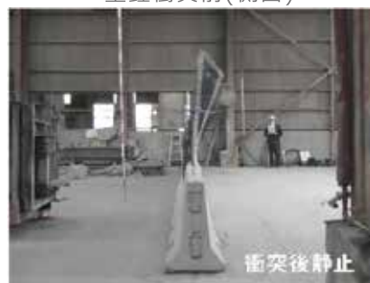
重錘衝突後の最大変形(側面)
