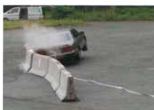
車両後部が防護柵に衝突
