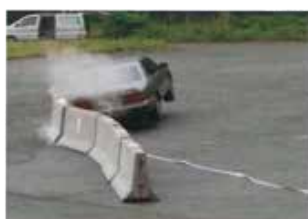
車両後部が防護柵に衝突
