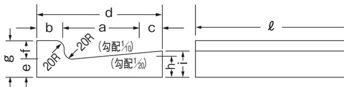
鉄筋コンクリートL形
